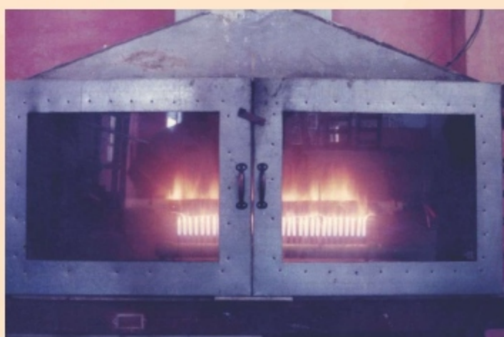
चित्र: आई ई सी-331 के अनुसार परीक्षण के दौरान केबल
