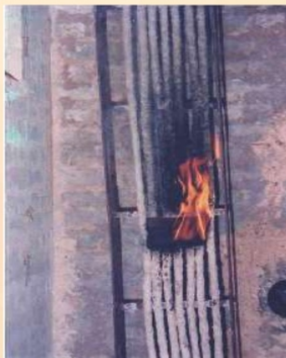
चित्र: आई ई ई ई .383 के अनुसार परीक्षण के दौरान केबल
